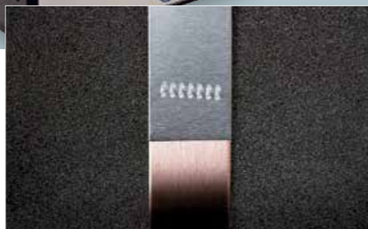
上下2つの金属(アルミと銅)が接合されている様子。2つの金属を重ねて上から折り返しのない精円の超音波複合振動(軌跡)を与えて溶解させずに原子レベルで金属を接合する
